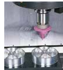
La pressione dell'aria pulisce i pezzi lavorati.
