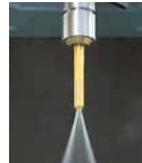
Attraverso l'utensil Utensile con fori
