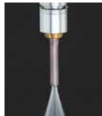
Attraverso l'utensile Utensile con fori
